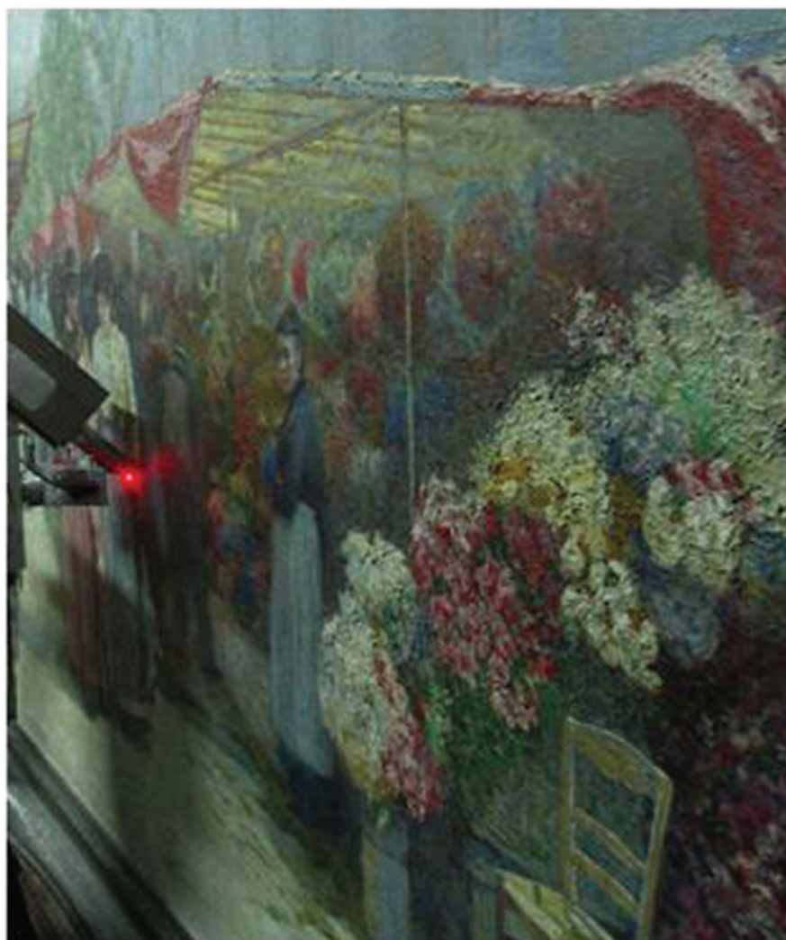
Obraz Józefa Pankiewicza Targ na kwiaty (1890) w trakcie pomiaru przenośnym spektrometrem XRF (konstrukcja aparatury IMP PAN Gdańsk)
