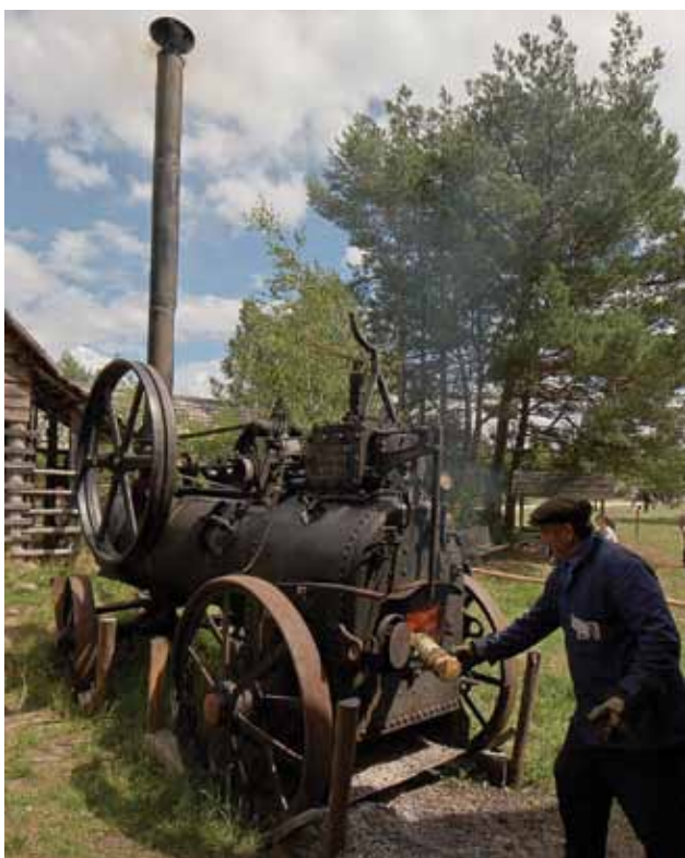
Lokomobila parowa – czynny zabytek dawnej techniki użytkowana w zespole tartacznym w Muzeum we Wdzydzach. Fot. Lech Zdrojewski
