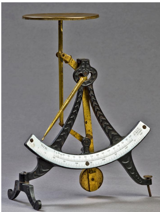
Waga listowa uchylna do udźwigu 15-500 g, prod. Philipp Jacob Maul, Hamburg, ok. 1905 r. Zbiory własne Muzeum Poczty i Telekomunikacji we Wrocławiu. Fot. R.M. Soldek
