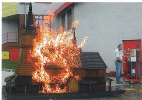
▲ System gaszenia mgłą wodną jest szansą na ocalenie wielu zabytków przed podpaleniem, pożarem i zniszczeniem. Fot. autor
