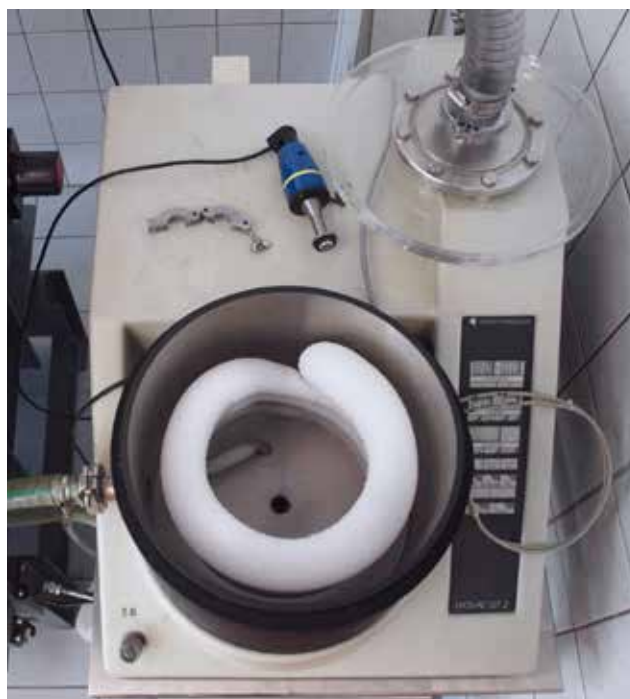
Biblioteka Narodowa, Instytut Konserwacji Zbiorów Bibliotecznych – kondensat wody w fazie stałej (lód) na rurce wymrażacza, fot. Jakub Piechal
