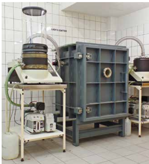
Biblioteka Narodowa, Instytut Konserwacji Zbiorów Bibliotecznych – komora liofilizatora z dwoma zestawami układów sterujących, pomp próżniowych i wymrażacza, fot. Jakub Piechal
