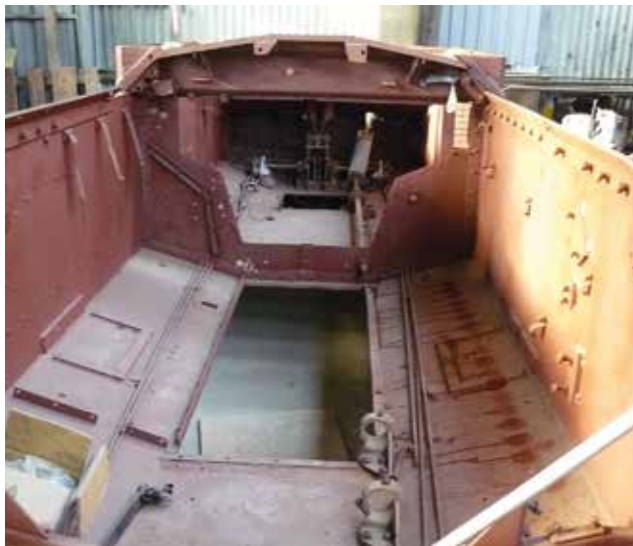
Kolejne etapy konserwacji kadłuba czołgu. Zdjęcie górne: po demontażu pancierza widoczny przedział napędowy. Zdjęcie środkowe: kadłub przygotowany do piaskowania. Zdjęcie dolne: kadłub po piaskowaniu i zabezpieczeniu przed korozją
