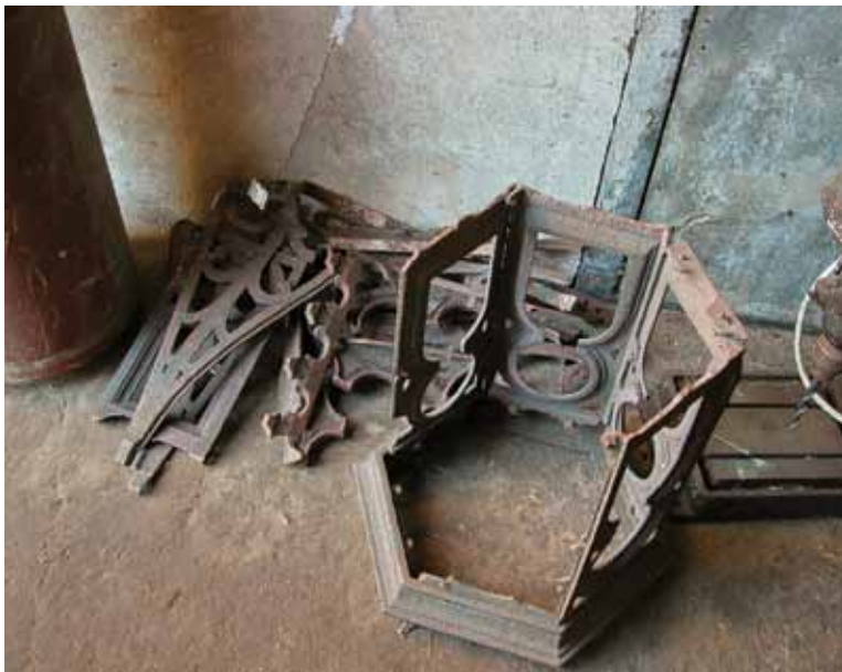
Fragmety zwieńczenia kaplicy przechowywane w magazynie nadleśnictwa po zniszczeniu połączeń śrubowych na skutek rozwoju procesów korozyjnych.
